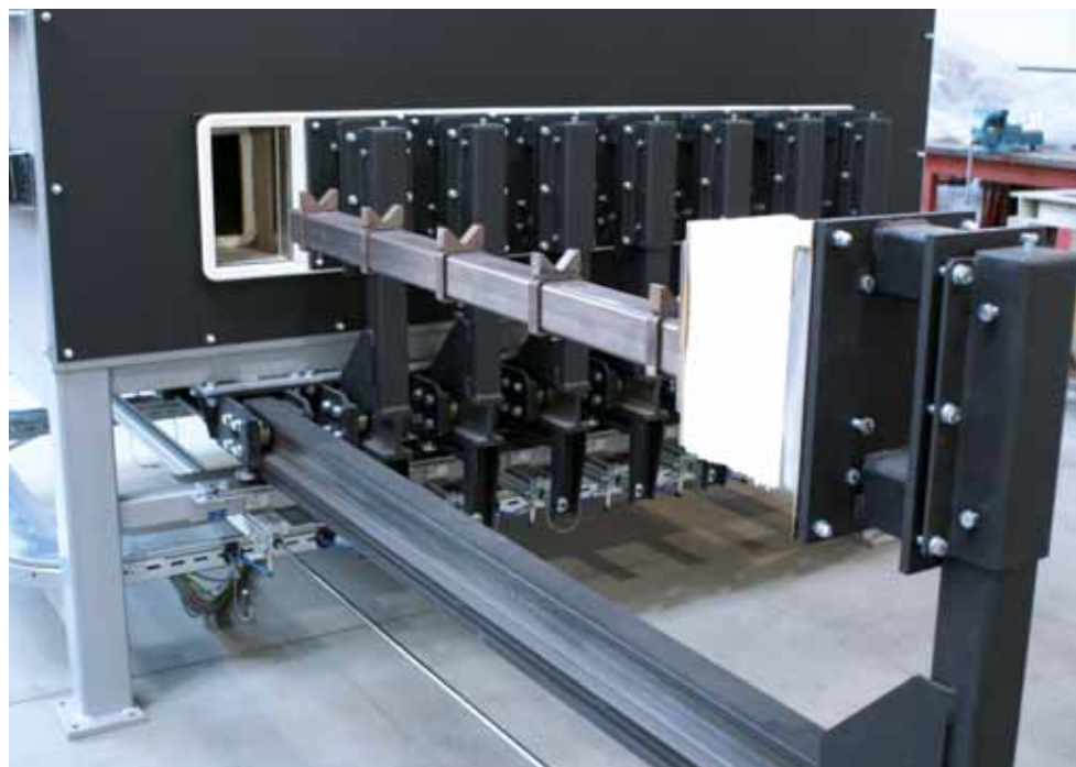
Offene Ofentüre mit Chargenaufnahmeprofil vor dem Einlegen des Werkstücks.
